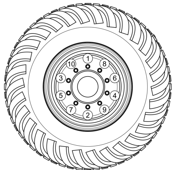
RYSUNEK 5.4 Kolejność odkręcania i dokręcania nakrętek
